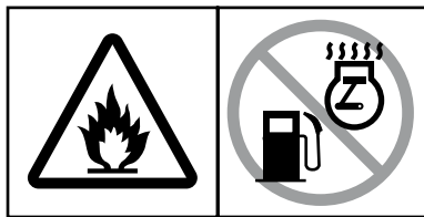
Bensin er meget brannfarlig. Slå av motoren og la den bli avkjølt før du fyller drivstoff.
